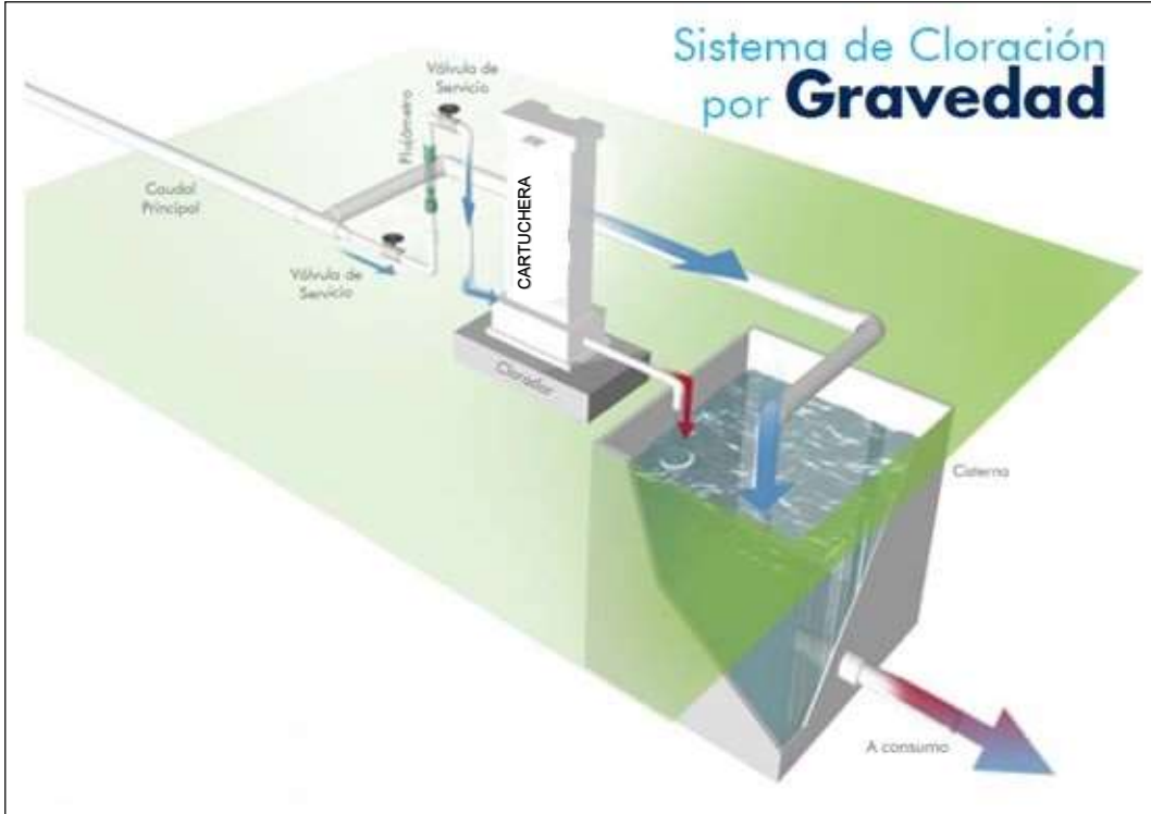
Esquema general de la instalación del sistema de cloración
