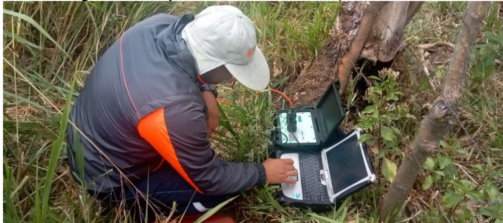
Fotografía 5.5 Ensayo de refracción sísmica en la planta de tratamiento
